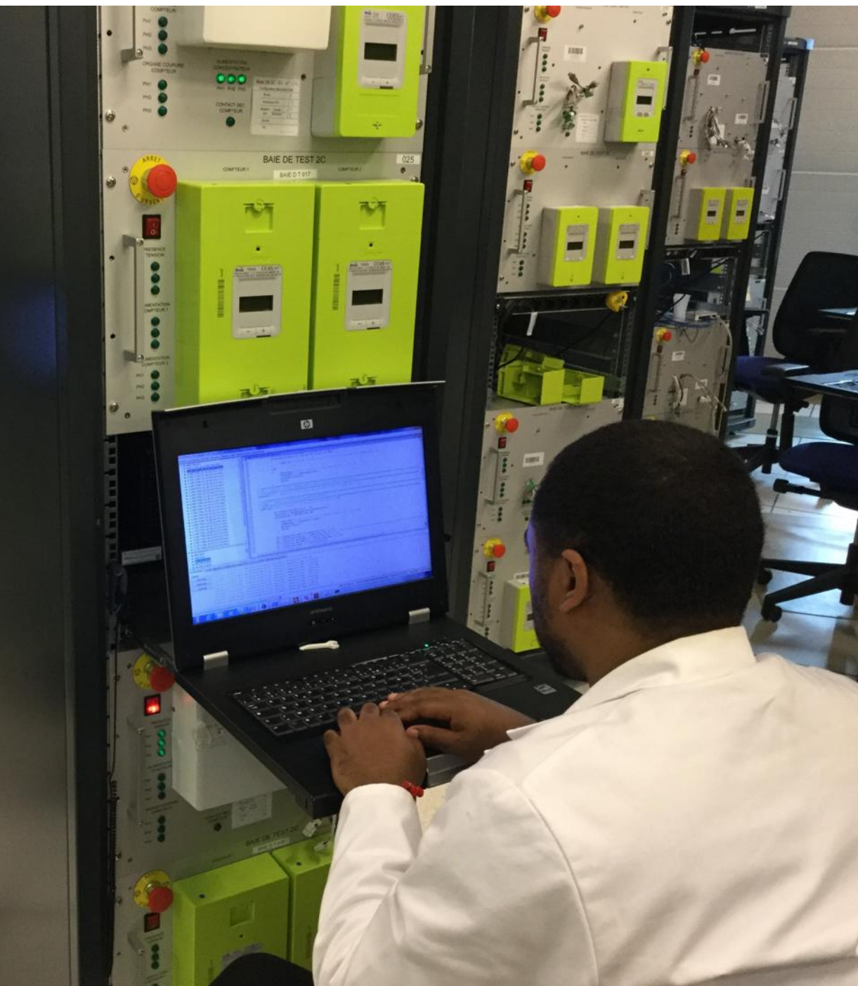
Linky, le compteur électronique dernière génération est déployé par Enedis depuis décembre 2015 à la suite de la loi du 17 août 2015. Ici, le Linkylab à Nanterre où sont testés les compteurs censés durer vingt ans. Ph. RL
